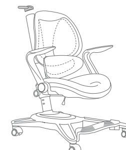
06 Присоедините ручку на перекладину, и надавите до щелчка. Чтобы снять ручку, надавите на рычажки сбоку ручки и достаньте её
